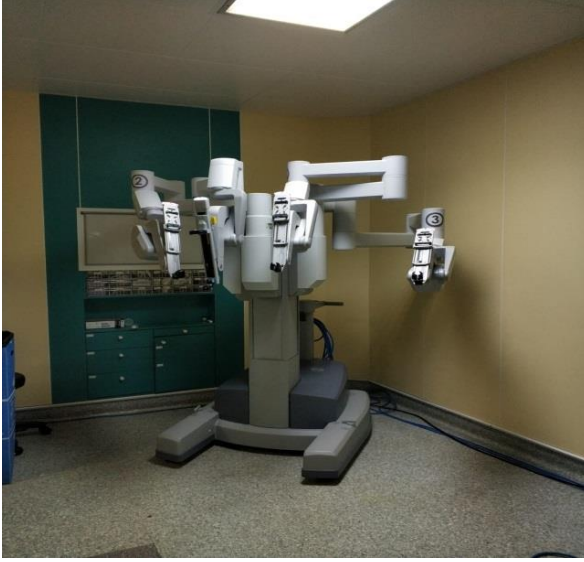
Resim-3. Da Vinci Robotik Cerrahi Sistemi 'Cerrahi Kollar'
