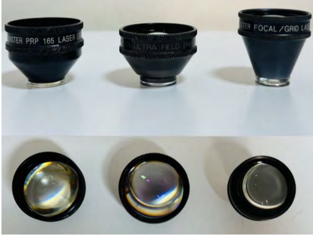
Şekil-9. Kliniğimizde kullanılan bazı kontakt biyomikroskopi lensleri. Üst fotoğrafta soldan sağa doğru Mainster PRP 165, Mainster Ultra Field PRP ve Mainster Focal/Grid modeli görülmektedir. Alt fotoğrafta yine aynı sırayla bu lenslerin üstten görünüşleri görülmektedir.
