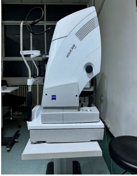
Şekil-2. Kliniğimizde kullanımda olan Visucam 524 (Zeiss, Oberkochen, Almanya) fundus kamera.
