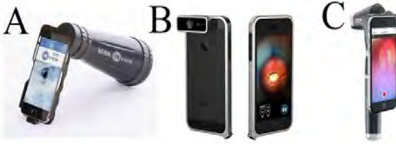
Şekil-4. Akıllı telefona entegre fundus görüntüleme sistemleri (5). A) iNview (Volk Optical, Ohio, Amerika Birleşik Devletleri). B) D-Eye (D-Eye Srl, Padova, İtalya) C) Welch Allyn iExaminer (Welch Allyn, New York, Amerika Birleşik Devletleri).
