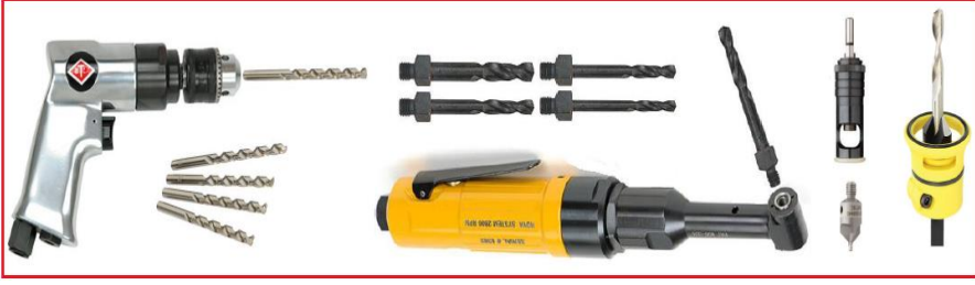
Şekil 3. Delik delmede kullanılan ekipmanlar (Aircraft tool supply company, 2021)
