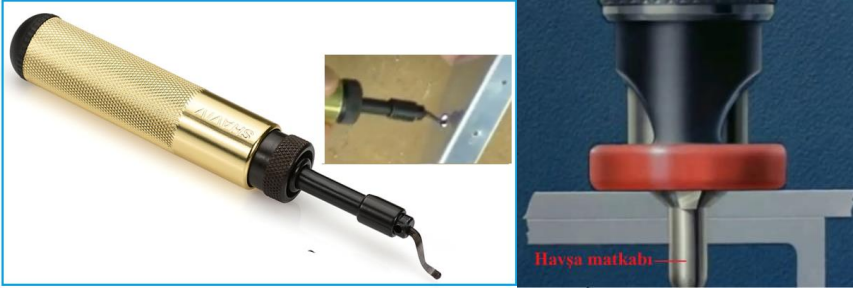
Şekil 4. Çapak alma işlemi ve havşa açma işlemi (Youtube, 2014a)
