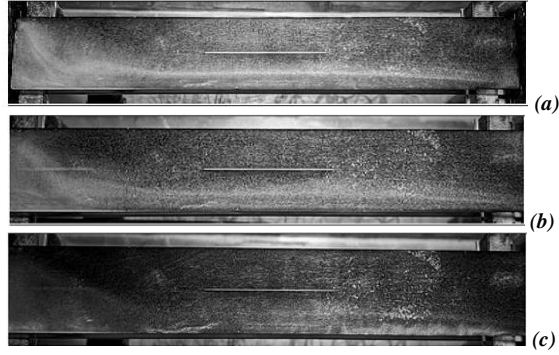
Şekil 7: Yüksek arttırıcı filtre uygulanmış dairesel mıknatıslayıcı akım görüntüsü (a) 450 A, (b) 650 A, (c) 850 A
