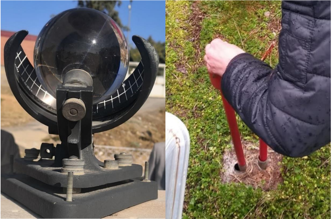
Fotoğraf 1 ve 2. Manuel olarak ölçüm yapılıp kaydedilen bir helyograf ve toprakaltı termometresi
