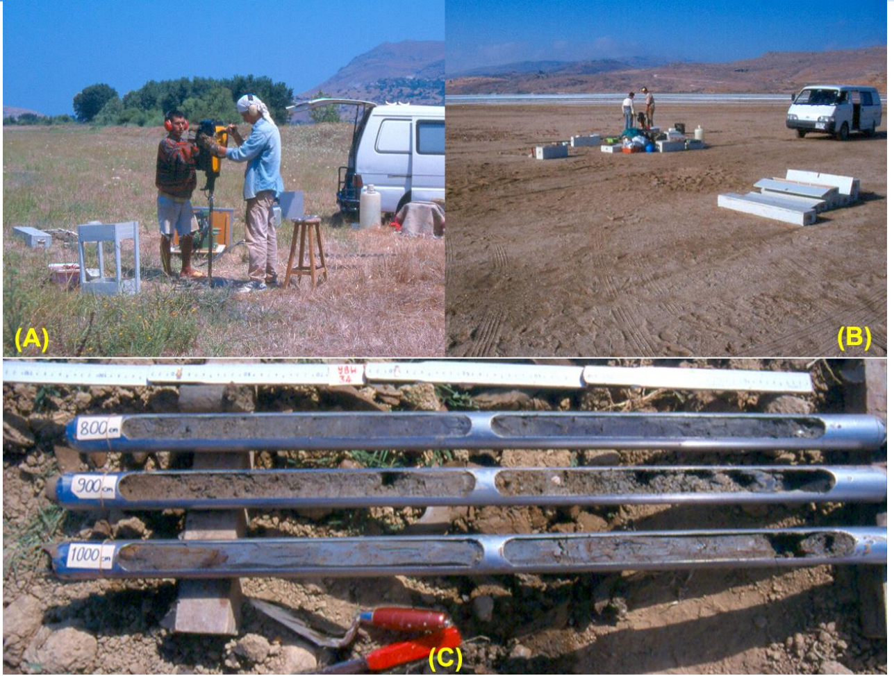
Foto 1A, B, C: Büyük Dere vadi tabanı (A) ve Tuz Gölü (B) çevresinde yapılan delgi sondaj çalışmaları ile sondajlardan elde edilen sediman örnekleri (C).
