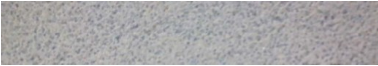
Şekil 5: BOEING el kitabında tavsiye edilen yüksek poroziteli taşlama taşı
