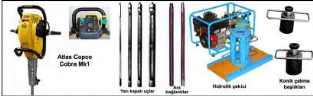
Şekil 5. Damlıboğaz ovasında sondaj çalışmalarında kullanılan benzin motorlu vurma başlıklı Atlas Copco şirketinin Cobra Mk1 modeli ile sondaj ekipmanları (Öner 2013; Öner, 2016a; 2016b; Öner ve İlhan, 2018).
