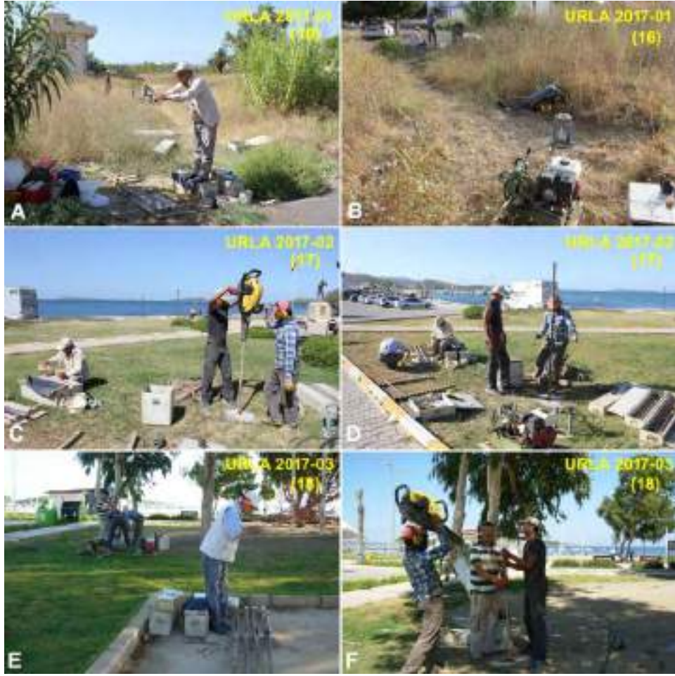
Şekil 5. Urla-İskele düzlüğünde 2017 yılında gerçekleştirilen delgi-sondaj çalışmalarından görüntüler. (Sondaj yerleri için Şekil 2'ye bakınız.).
