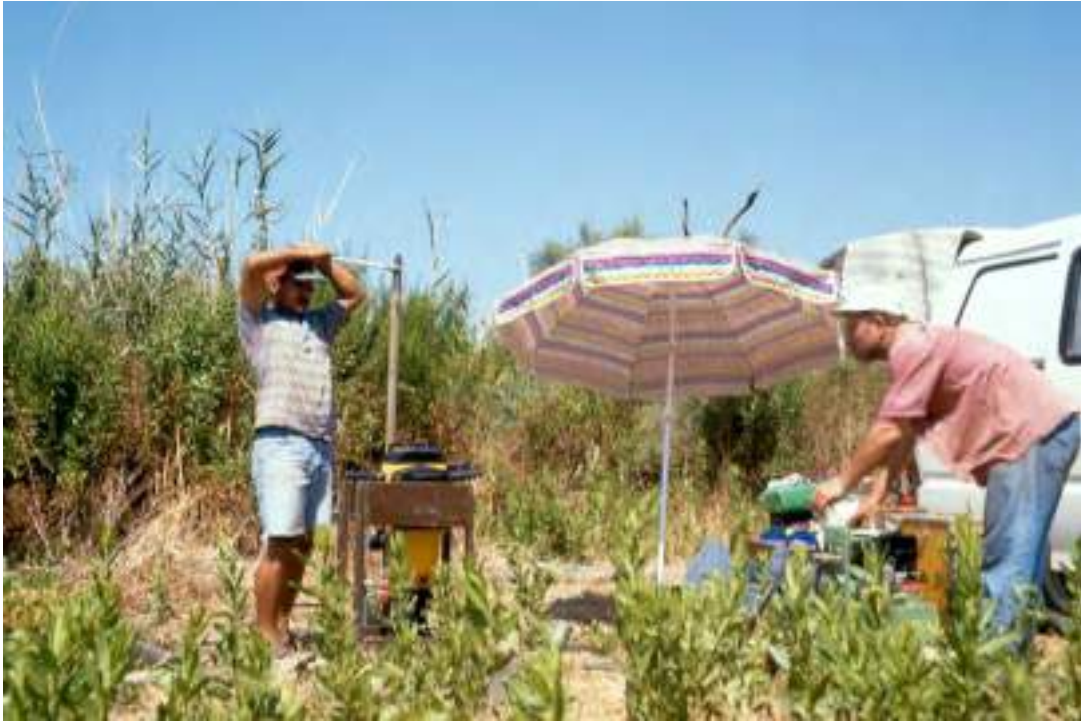
Foto 3. Eşen ovası ve Patara oluğunda benzin motorlu makinelerle delgi sondaj çalışmaları yapılmıştır.
